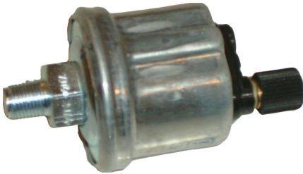
Figura 8 Esempio di sensore pressione olio 1/8"- 27 0-120 PSI
